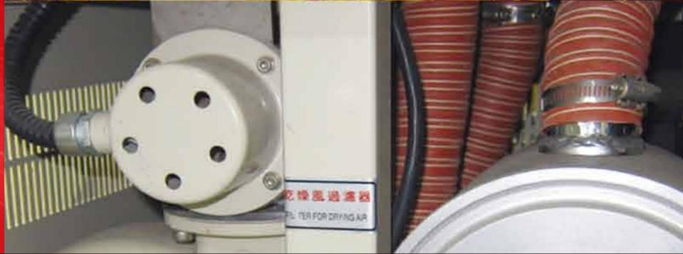
**5 MANGUERA DE ALTA TEMPERATURA PARA EXTRACCIÓN**
